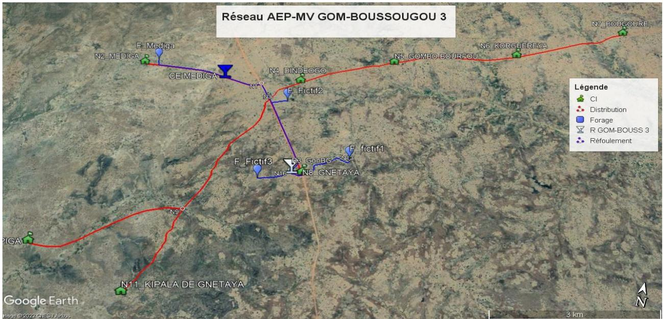
Figure 33: Réseau AEP-MV Gonboussougou\_3
