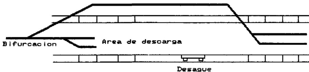
El relleno se realizará en capas, con espesor dependiente de las cualidades del subsuelo sobre el cual se efectúa el relleno y de la compresibilidad y estabilidad de las ataguías sin y con relleno. También el progreso vertical en el tiempo depende de estos factores. El desarrollo vertical de las se realiza como se indica en el esquema siguiente:
