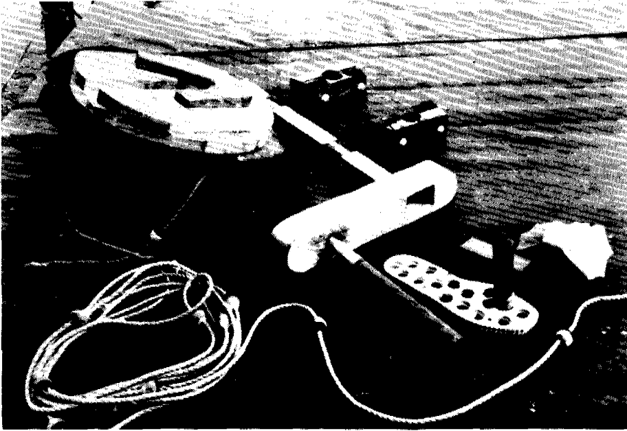
Figure 2.4 Les pompes à chapelet hydraulique permettent d'utiliser au maximum les matériaux locaux. Elles se prêtent surtout aux faibles hauteurs d'élévation et conviennent à de petits groupes d'utilisateurs (photo Consultants WASTE).
