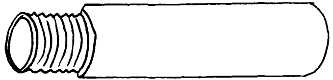
20 cm de tuyau galvanisé fileté
