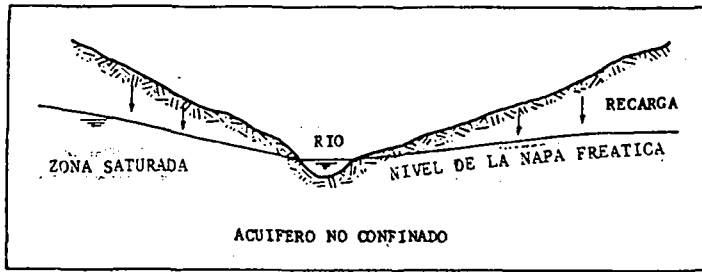
Figura 7.4a Filtración de agua en un acuífero no confinado durante la estación húmeda
